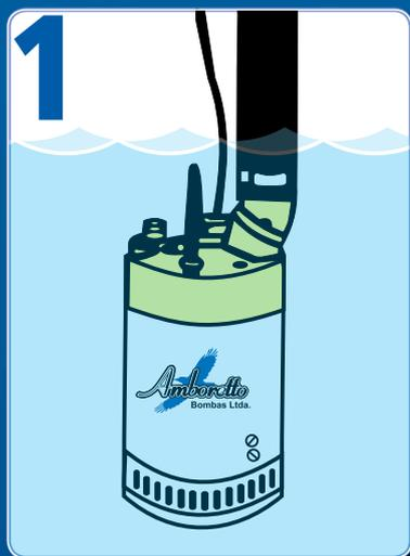
Observe-se que a bomba só entrará em funcionamento quando o nível da água atingir a sua tampa amarela, fazendo com que o circuito elétrico seja conectado através dos eletrodos.
